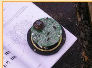
Acelerómetro © BRGM
